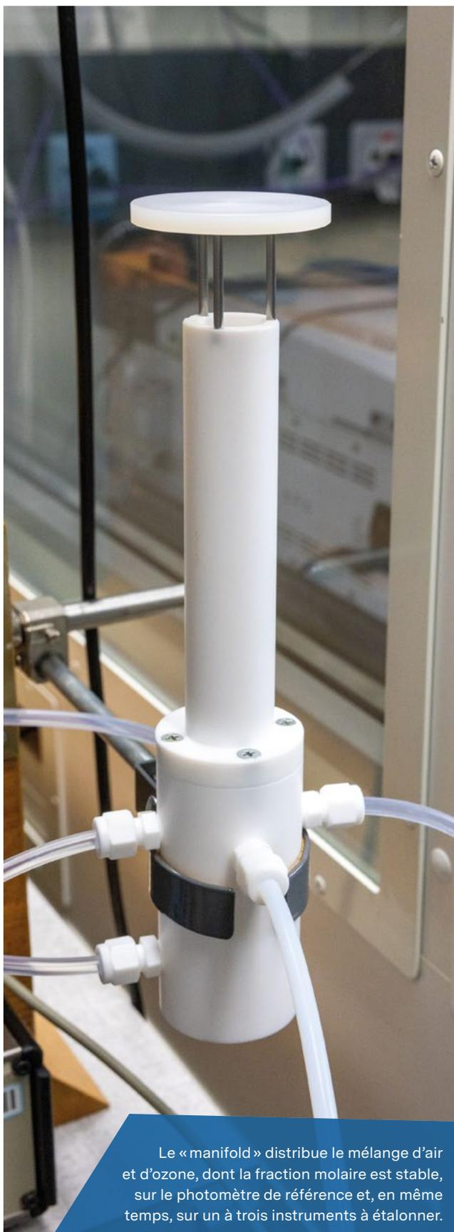
Le « manifold » distribue le mélange d'air et d'ozone, dont la fraction molaire est stable, sur le photomètre de référence et, en même temps, sur un à trois instruments à étalonner.
