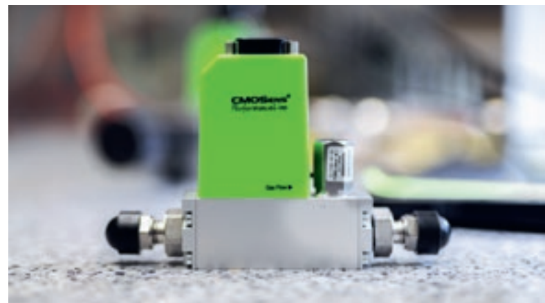
1: Ein Massendurchflussregler (Mass flow controller, MFC) regelt einen Massenstrom auf einen Sollwert und kann mit Kolbennormalen kalibriert werden.
