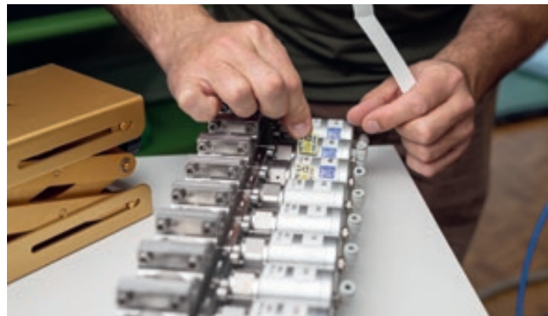
4: Die 12-Venturi-Düsen wurden vor rund 5 Jahren bei der PTB in Braunschweig mit nahezu deckungsgleichen Ergebnissen gegenüber den Messwerten des METAS kalibriert.
