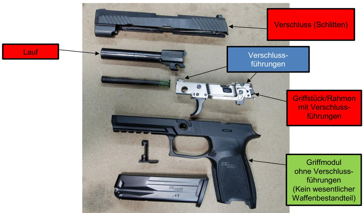
Bei der Pistole SIG SAUER P250 und SIG SAUER P320 wird jenes Teil als **Rahmen** bezeichnet, an welchem sich insbesondere die Verschlussführungen befinden sowie die Abzug- und Schlageinheit integriert ist. In dieser konstruktionsweise ist der **Rahmen dem Griffstück gleichzusetzen** und gilt bei diesen Pistolen somit als **wesentlicher Waffenbestandteil im Sinne von Art. 3 Bst. a Ziffer 1 WV** und ist gemäss Art. 18a WG i.V.m. Art. 31 WV zu markieren.
