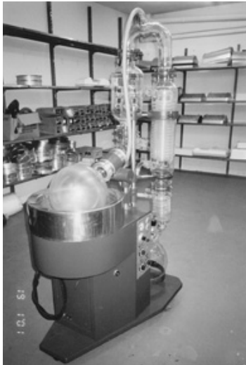
Distillation. Evaporateur rotatif pouvant être utilisé pour la fabrication d'huile de cannabis.
